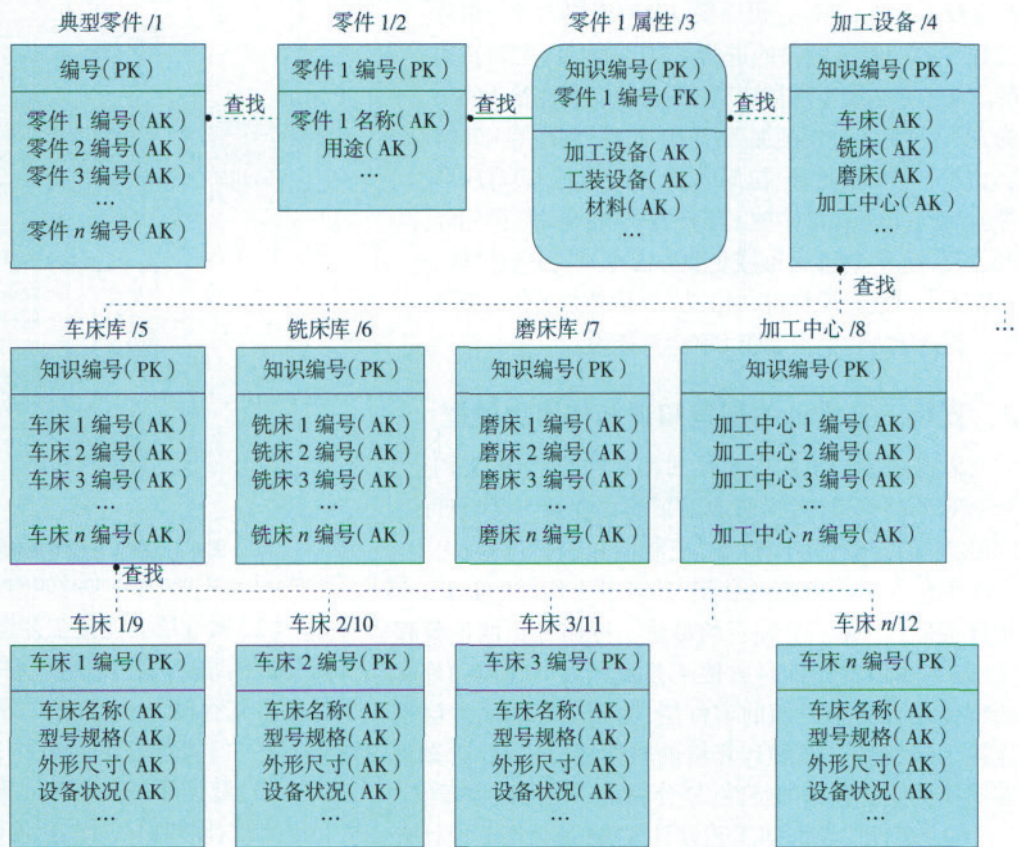
图4 支持工艺设计的制造设备知识表达模型
